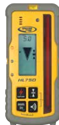
Dalmierz laserowy HL750 do pomiaru i wyświetlania lokalizacji lasera
